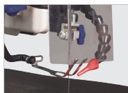
· Equipado con hoja de protección, pieza de sujeción y tubo soplador flexible.
